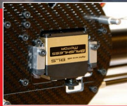
Das Heckservo sitzt stehend in einer Aussparung an der linken Chassisseite und lenkt den Heckrotor geradlinig innen unterhalb des Heckrohrs an.
