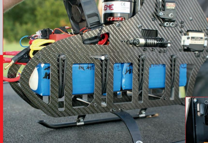
Der Akku sitzt gut geschützt im Innern der Mechanik. Er wird mit vier Gummiringen an gummiummantelte Rollen ins Oberteil gezogen, was einen schnellen Akkuwechsel und sicheren Halt gewährleistet. Sehr gut gelöst: Der Akku sitzt vollständig geschützt innerhalb der Mechanik.
