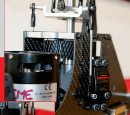
Die Taumelscheibenanlenkungen verlaufen durch geschickte Positionierung der Servos absolut gerade. Die Plattform hinter der Rotorwelle bietet genug Platz für alle gängigen Flybarless-Systeme.
