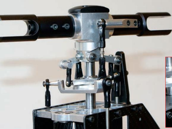
Der Rotorkopf ist vollständig aus Aluminium gefertigt. Für alle Anlenkungen werden 6-mm-Kugelpfannen und -bolzen verwendet. Ein Rechts-Links-Gewinde an der Rotorblattanlenkung ermöglicht die exakte Einstellung des Spurlaufs. Praktisch: Den Bausätzen liegt ein zu den Kugelpfannen passender Maulschlüssel bei.
