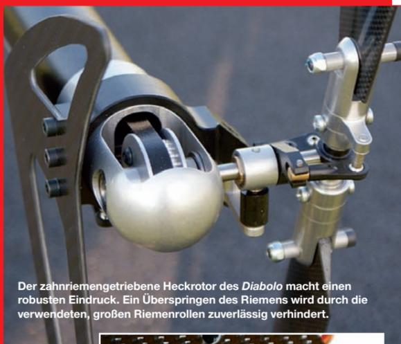
Der Zahnriemengetriebene Heckrotor des Diabolo macht einen robusten Eindruck. Ein Überspringen des Riemens wird durch die verwendeten, großen Riemenrollen zuverlässig verhindert.
