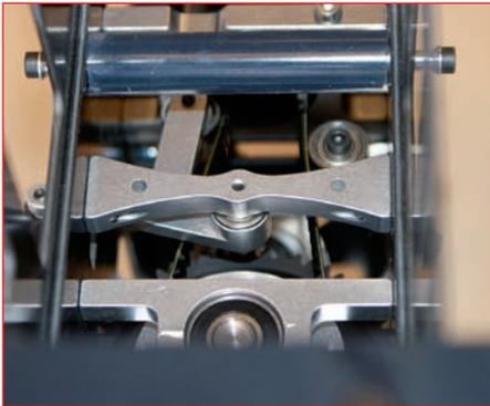
Ein Riemenspanner sorgt für immer konstante Spannung des Zahnriemens und unterbindet zuverlässig dessen Flattern. Für Vorspannung und Dämpfung hat sich ein Stoßdämpfer aus dem RC-Car-Bereich als optimal erwiesen.
