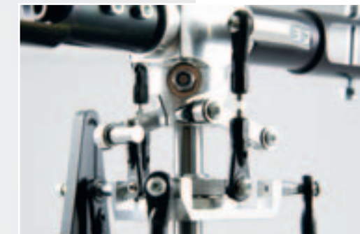
Hauptrotorkopf, Mitnehmer und Taumelscheibe sind montiert. Die Kugelgelenke werden durch Schraubenköpfe vor einem Abspringen gesichert
