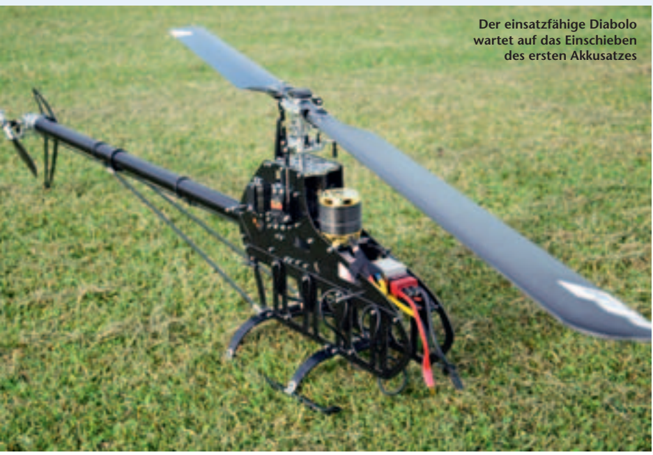
Empfänger und Flybarless-System sind im hinteren Bereich verstaut. Deutlich zu erkennen ist auch das Nickservo
