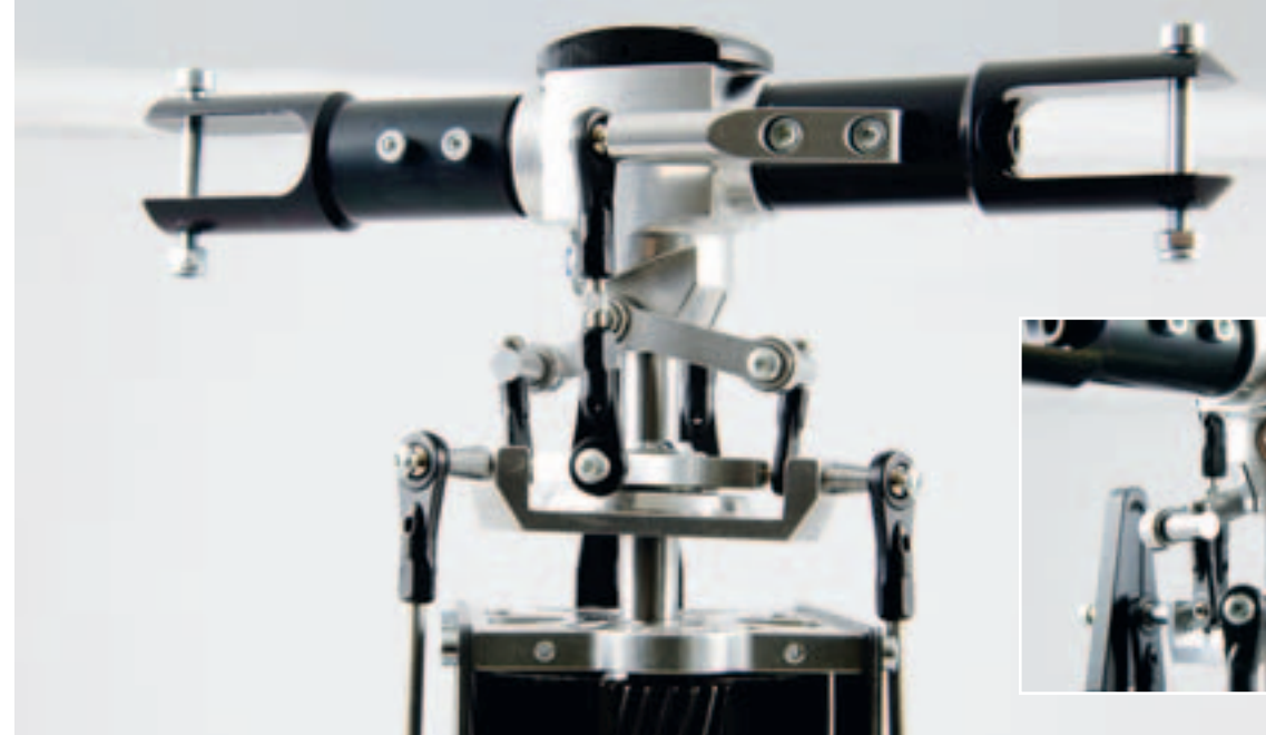
Hauptrotorkopf, Mitnehmer und Taumelscheibe sind montiert. Die Kugelgelenke werden durch Schraubenköpfe vor einem Abspringen gesichert
