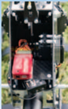
Empfänger und Flybarless-System sind im hinteren Bereich verstaut. Deutlich zu erkennen ist auch das Nickservo
