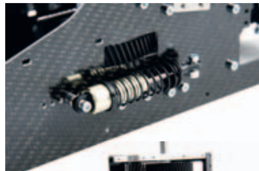
Die Vorspannung des Öldruckstoßdämpfers, der den Riemenanddruck vorgibt, kann verstellt werden
