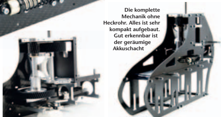
Das zweistufige Getriebe befindet sich auf dem rechten CFK-Seitenteil – die Montage der linken Chassisplatte steht kurz bevor
